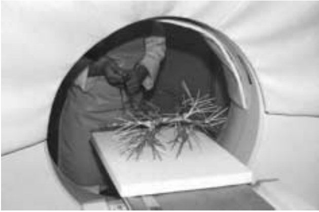
Fig. 1 最初のヘリカルスキャンの実験(1987年11月17日) アルミニウムでできた肺の模型を手で引っ張った。こんな簡単な実験からヘリカルスキャンは始まったのである。
