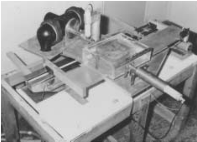
Photo. 3 ハンスフィールドによる最初のCT実験装置。奥にエックス線管, 手前にシンチレーションカウンタが見える。テーブルには直線運動を行うためのレールがつけられている。
