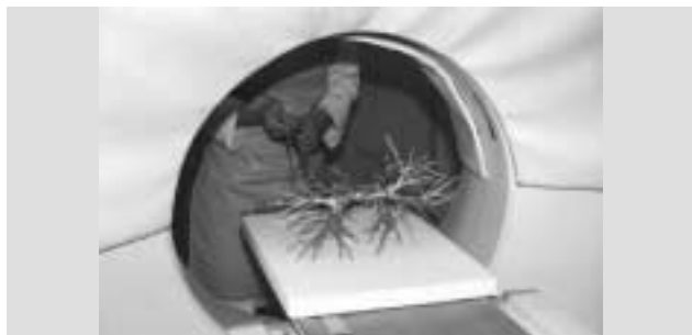
Photo. 7 最初のヘリカルスキャンの実験(1987年11月)。胸部血管模型に紐をつけ、連続ダイナミックスキャン中に手で引っ張るといった原始的な実験を行った。
